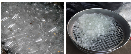
Hình 4: Thủy tinh y tế sử dụng trong thí nghiệm (Nguồn: Kết quả thí nghiệm của đề tài "Thiết kế cấp phối bê tông cấp bền B15 cốt liệu thủy tinh y tế và cát nghiền" của tác giả năm 2017)
