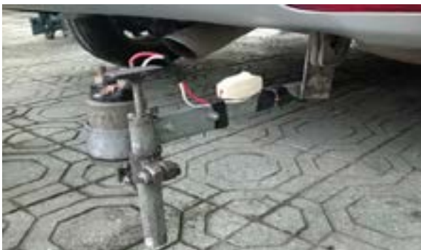
Hình 11. Lắp thiết bị đánh dấu vị trí bắt đầu phanh vào xe
