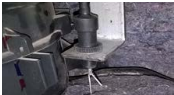
Hình 9. Công tắc bàn đạp phanh phụ
