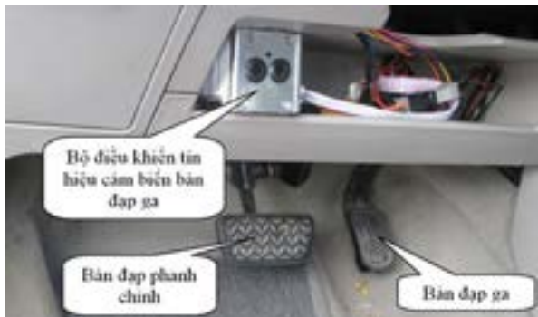
Hình 7. Vị trí lắp bộ điều khiển
