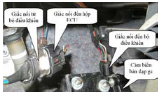
Hình 8. Vị trí kết nối với bộ điều khiển
